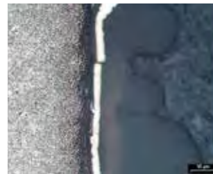
Diffusionszone, keine Verbindungsschicht
