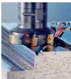
Einfahrt per „Roll-In“ Verfahren Verschleiß nach 800 Bearbeitungsgängen
