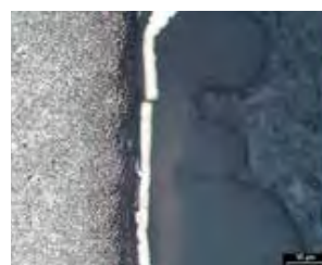
Diffusionszone, keine Verbindungsschicht
