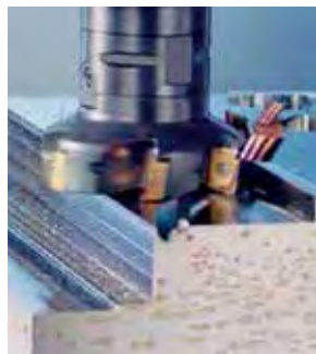
Einfahrt per „Roll-In“ Verfahren Verschleiß nach 800 Bearbeitungsgängen
