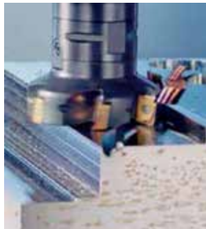
Einfahrt per „Roll-In“ Verfahren Verschleiß nach 800 Bearbeitungsgängen
